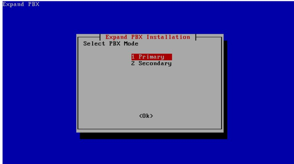
**Selección del tipo de PBX** - eXpand permite una instalación presente o futura en un esquema de alta disponibilidad con la presencia de dos nodos. En ese caso, el nodo secundario toma el rol del primario si este deja de funcionar por algún inconveniente. La primera instalación corresponde al nodo primario.
